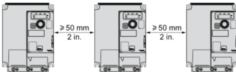
Sólo es posible a una temperatura ambiente inferior o igual a  $50 \text{ }^{\circ}\text{C}$  ( $122 \text{ }^{\circ}\text{F}$ )
