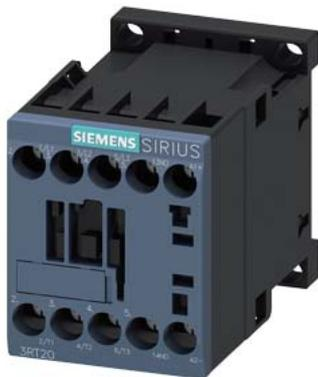
contactor de potencia, AC-3e/AC-3, 7 A, 3 kW/400 V, tripolar, 24 V DC, contactos auxiliares: 1 NA, borne de tornillo, tamaño: S00
